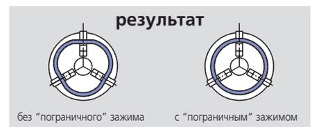
Результат – круглые детали с минимальной деформацией. "Пограничный" цикл программируется и полностью завершается в течение 2-4 секунд.
