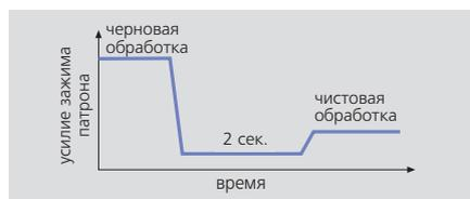
При этом требуются SMW-AUTOBLOK цилиндры с закрытым центром типа SIN-HL и доработка гидросистемы станка. В указанной выше комбинации клиноременная система KNCS-NB/KNCS-NBX позволяет осуществлять управляемое снижение усилия зажима. Деталь остается надежно зажатой в патроне, при этом избыточная нагрузка на деталь может быть устранена.
