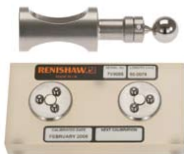
Комплект принадлежностей к системе QC20-W для диагностики по окружности малого радиуса
